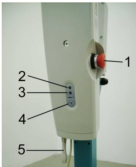
Die Steuer-/Akkueinheit ist am Lifter fest installiert. An ihr befinden sich die NOT-AUS-Taste (**Abb. 4 Pos. 1**), die Ladekontrolleuchte (**Abb. 4 Pos. 2**) und die Batteriezustandsanzeige (**Abb. 4 Pos. 3**). An der Steuer-/Akkueinheit befinden sich ferner die elektrische Notabsenkung (**Abb. 4 Pos. 4**) und der Ladeadapter (**Abb. 4 Pos. 5**).
