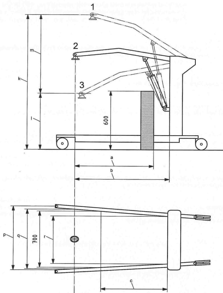
Abb. 12: Schematische Darstellung nach EN ISO 10535:2006
